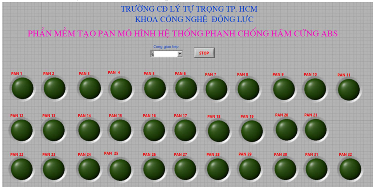
Hình 4: Giao diện chương trình tạo pan hư hỏng trên phần mềm LabView
